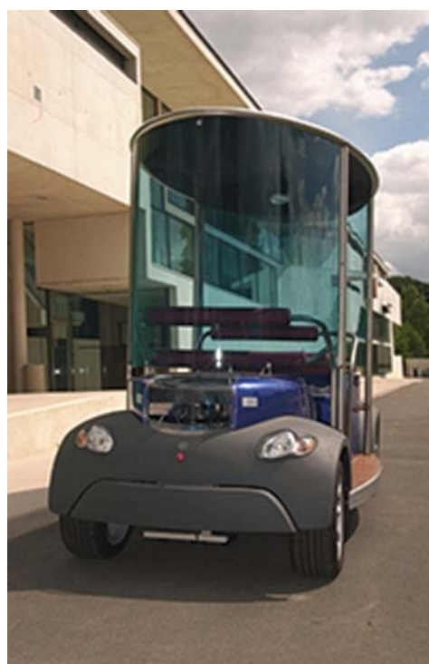
Fig. 8.3 - Fotografia de um Cybercar - veículo eléctrico sem condutor para utilização em centros históricos num projecto piloto em Coimbra (Fonte: Universidade de Coimbra; www.cybercars.org ).
